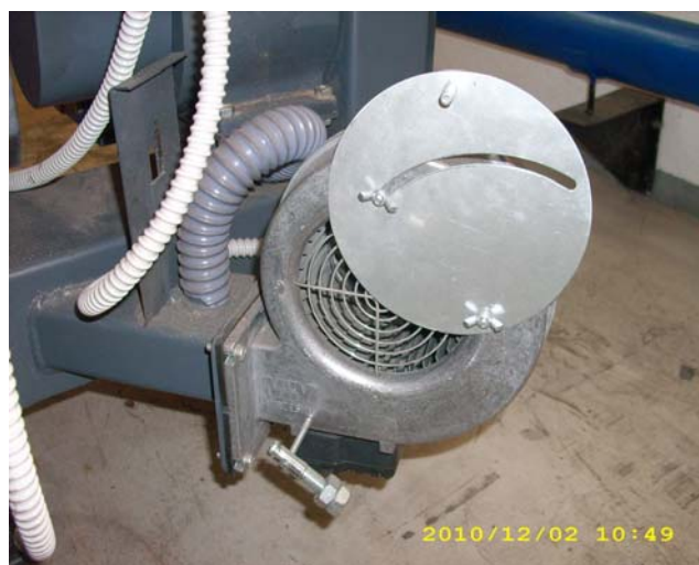
Рисунок 8. Положение макс. открытого клапана вент.
