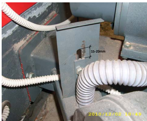
Рисунок 7. Положение клапана вентилятора
