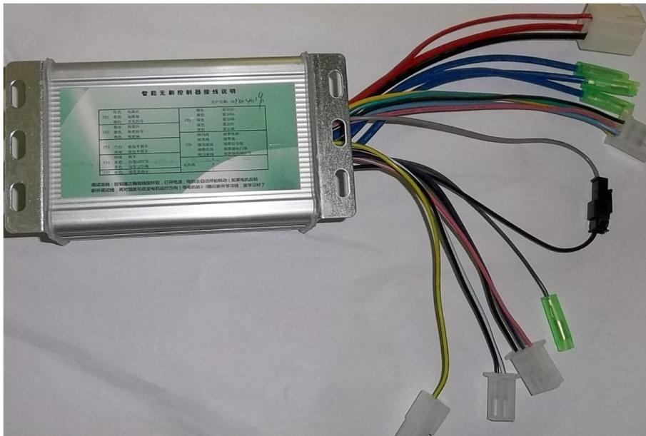
1. **Красный-Черный-Красный (тонкий).** Вход питания, тонкий красный на замок "зажигания" (по уровню напряжения на этом проводе контроллер определяет степень разрядки батареи, вы можете хоть от 12 вольт контроллер запитать, но на этом проводе должно быть "правильное" напряжение) .
