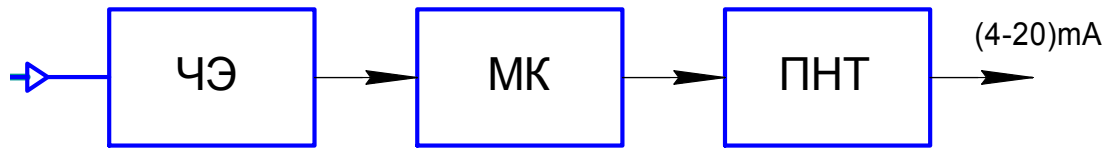
Рис.1 Структурная схема датчика.
