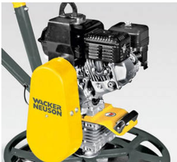
Бензиновый двигатель: мощный, четырехтактный, одноцилиндровый.
