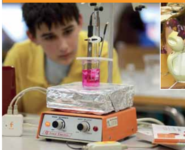
Исследование процесса скисания молока с помощью pH-метра
