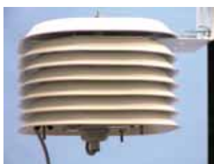
Солнцезащитный кожух с комбинированным датчиком температуры-влажности
