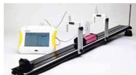
Измерение скорости движущегося объекта с помощью фотоворот
