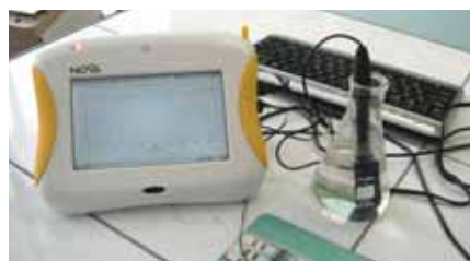
Измерение влияния концентрации раствора соли на его проводимость с помощью датчика электропроводимости
