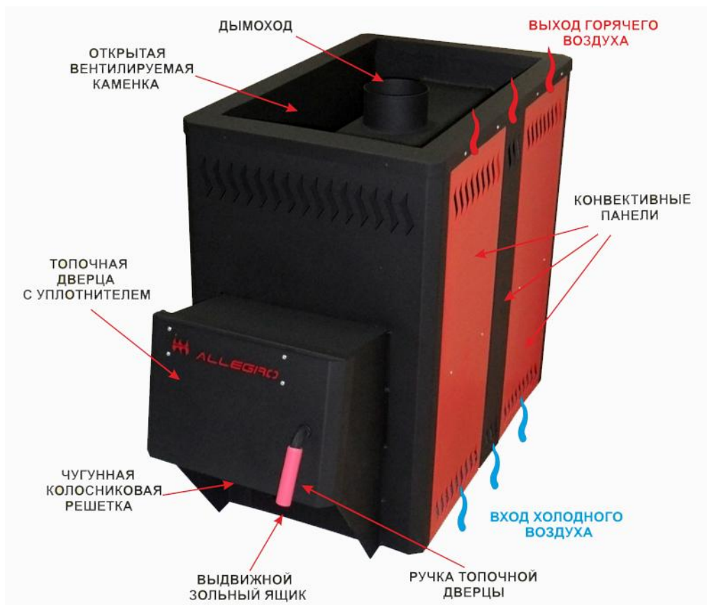
Рис. 2 Устройство печи ALLEGRO
