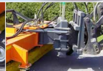
Optimale Boden-anpassung durch robusten 3D-Niveausgleich
