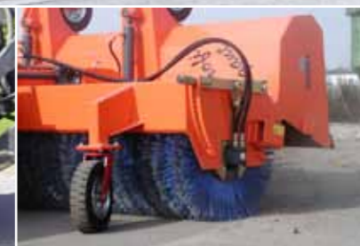
Einfache Bürstennachstellung über Rasthebelsystem
