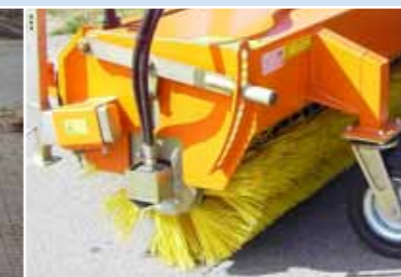
Zwei leistungsstarke, innenliegende Motoren für den Bürsteantrieb
