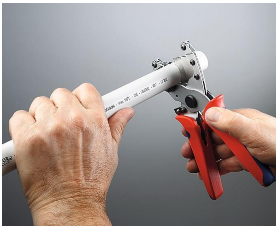
Рис. 1. Отрезание трубы при помощи труборезных ножниц
