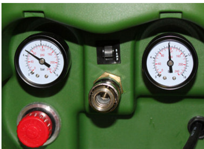
Органы контроля и управления: слева — манометр регулятора давления, под ним рукоятка регулятора давления; в центре — быстросъемный разъем, над ним кнопка тепловой защиты; справа — манометр, показывающий давление в ресивере
