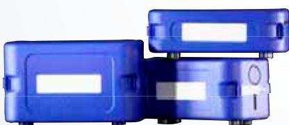
NIBE PLEX – это пластинчатый теплообменник, доступный в семи разных моделях. Пластины сделаны из кислотостойкой стали (SS 23 43). Изоляция выполнена из двух половин прессованного вспененного полиуретана толщиной 30 мм, что соответствует минеральной вате толщиной 70 мм. Поверхностный слой выполнен из пластика ABS.
