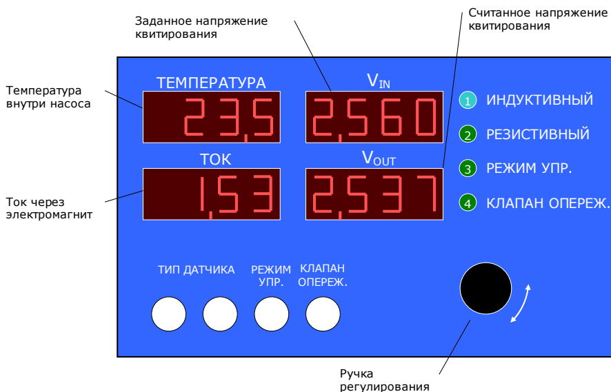
Рисунок 5. Органы управления и индикации
