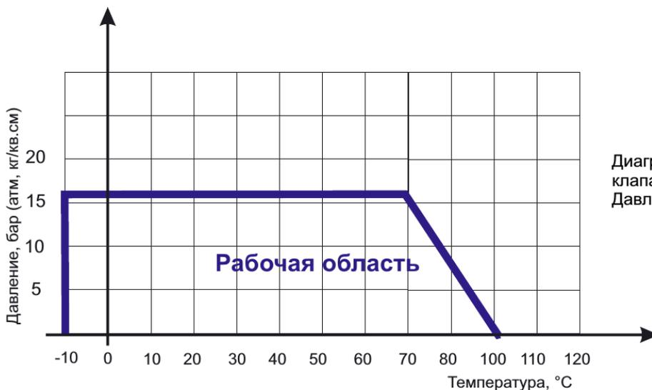
Диаграмма определяет рабочую область для клапанов обратных в координатах Давление (в барах приборного) / Температура (° C).
