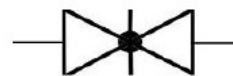
Вариант 4. Знак "Задвижка клиновья или шиберная". Шаровой кран так обозначать неверно, но обозначают так часто.
