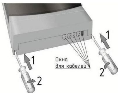
Рисунок 6 – Снятие крышки клеммного отсека
