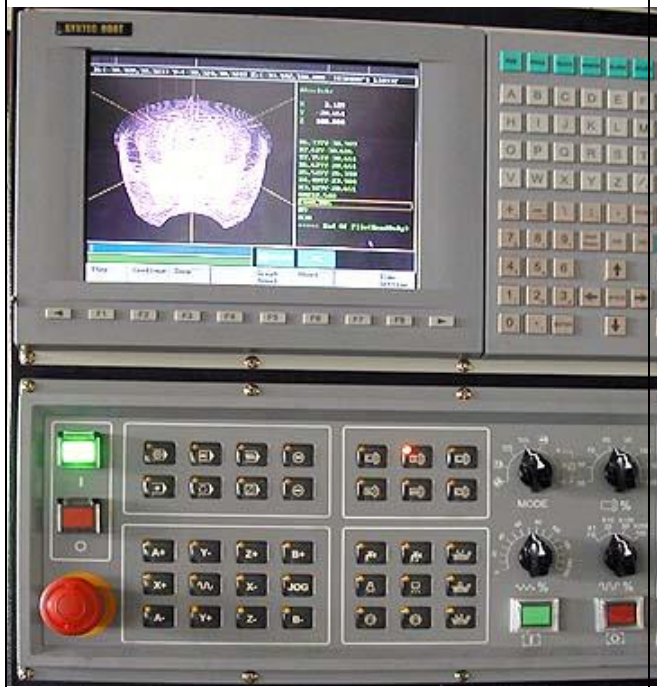
Внешний вид экрана ЧПУ и пульта системы ЧПУ SYNTEC 900ME (аналог Fanuc- 0M), 3D прорисовка пути инструмента перед началом обработки
