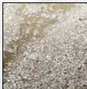
Панели, армированные полипропиленовыми волокнами Степень огнестойкости – не менее 120 минут
