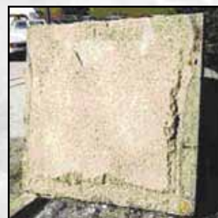
Панели, армированные полипропиленовыми волокнами Степень огнестойкости – не менее 120 минут
