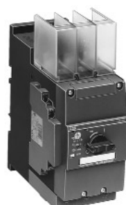
MS 495 с вспомогательным контактом К S4-02 и расцепителем рабочего тока AA 4 и крышкой зажимов KA 495 C
