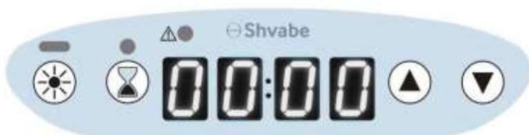
Рисунок 9 – Панель управления облучателя в подготовленном к работе состоянии
