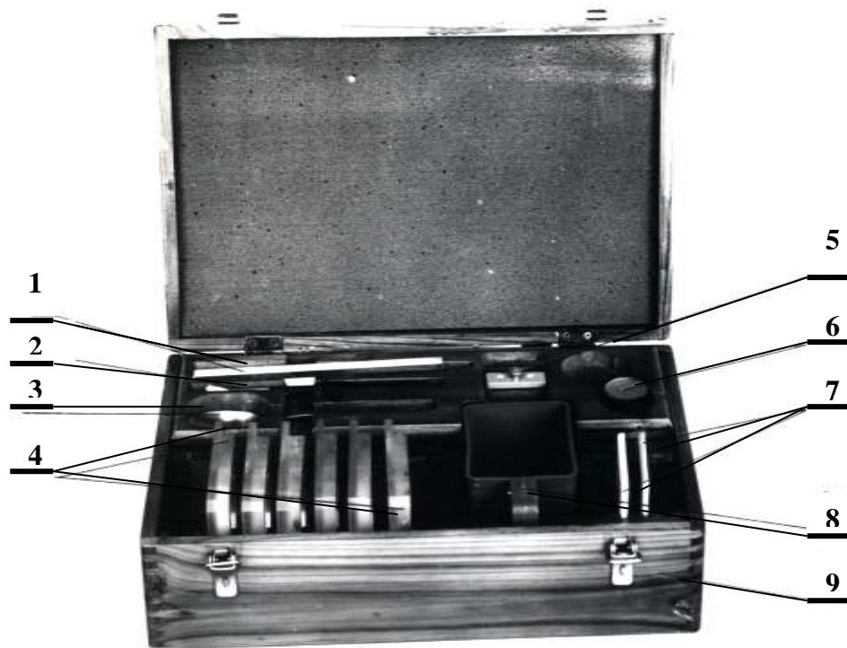
Рисунок 4 – Комплект принадлежностей и сменных частей: 1 – палочка уплотнительная для выравнивания и уплотнения контролируемого продукта в кювете; 2 – кисть для чистки предметного столика; 3 – ложка для заполнения кювет контролируемым продуктом; 4 – кюветы для муки; 5 – светофильтр в оправе №1; 6 – приспособление для юстировки лампы; 7 – пластины калибровочные №1 и №4 для подготовки прибора к измерениям и проверки прибора в процессе эксплуатации; 8 – сито для просеивания контролируемого продукта; 9 – футляр деревянный.
