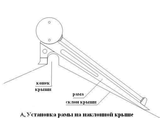
А, Установка рамы на наклонной крыше
