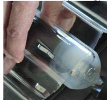
газопоглотитель разрушен, трубка неисправная
