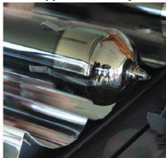
газопоглотитель в порядке, трубка исправная
