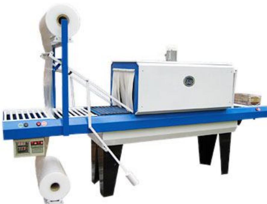
Удобный и эргономичный упаковочный аппарат для упаковки Пэт-тары, стеклянных емкостей, коробок. аппарат используют для упаковки отдельных изделий в блоки (например, несколько коробок, 20 бутылок и пр.) Проходная термокамера, регулятор температуры ножа и камеры, возможность доукомплектации аппарата регулятором скорости движения конвейера делают этот аппарат
