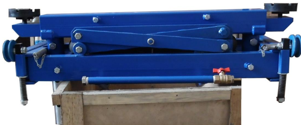
Рис. 3. Крайнее нижнее положение ножничного механизма
