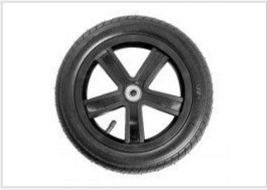
ОМО_701 Колесо большое камерное 12" x 2" 1/2
