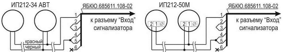
Рисунок Б.3 – Схема подключения пожарных извещателей
