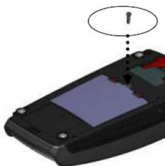
Рис. 13. Установка модуля считывания бесконтактных карт 3
