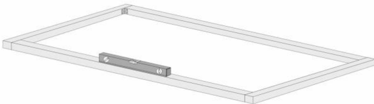
Рис № 1. Изготовление деревянного фундамента.
