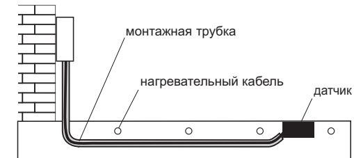
Рисунок 2. Способ монтажа датчика осадков при подогреве грунта.
