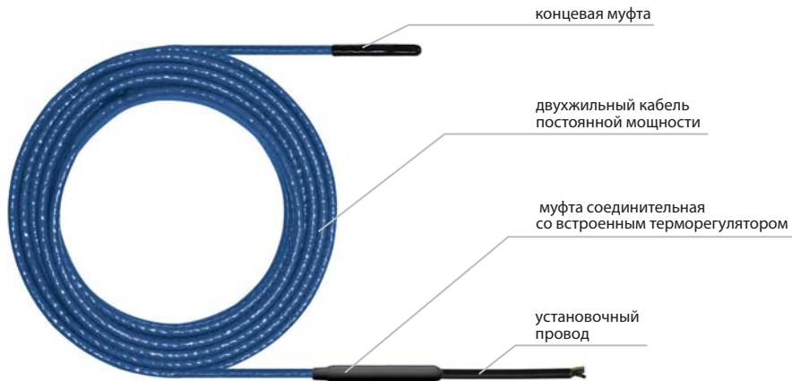
Рис. 1. Конструкция нагревательной секции
