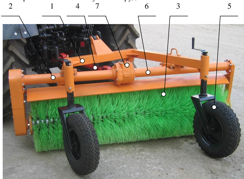
Рисунок 1. Устройство и основные узлы Оборудования щеточного.
