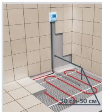
Схема укладки датчика температуры в гофрированной трубке
