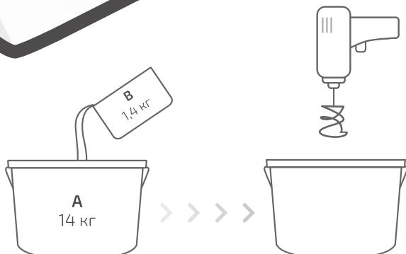
Двухкомпонентный тиоколовый герметик с повышенной стойкостью к УФ-облучению, высокой маслобензостойкостью и водостойкостью. «Сазиласт 21» предназначен для герметизации деформационных швов строительных конструкций с максимальной амплитудой знакопеременных циклических деформаций до 25%.
