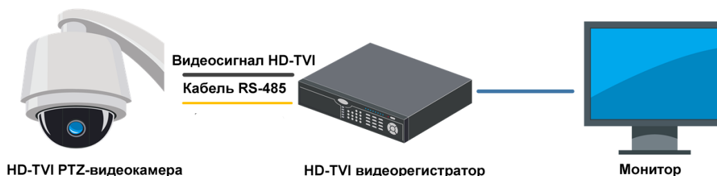
Рис. 2.3. Типичная схема управления через видеорегистратор
