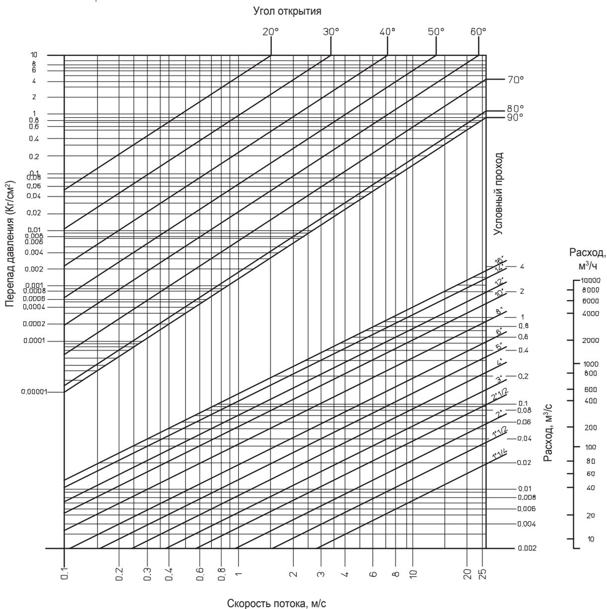
Kv - это коэффициент с размерностью м<sup>3</sup>/ч, отражающий расход воды при +15°C через клапан при перепаде давления на входе и выходе в 1 Бар.
