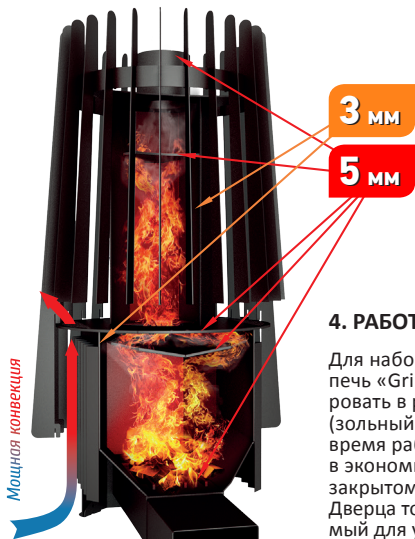
Рис. 4 Устройство и работа печи
