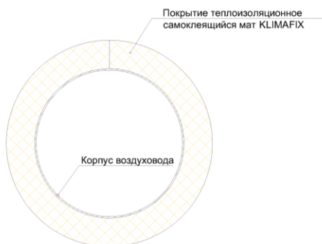
Рис. 5. Принципиальная схема расположения матов Klimafix по периметру воздуховода круглого сечения
