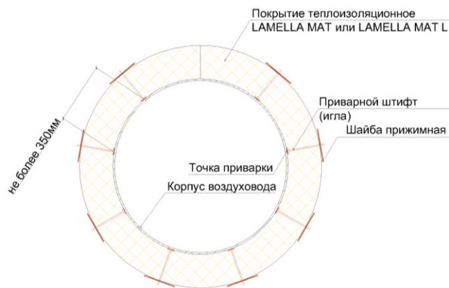
Рис. 2. Принципиальная схема расположения матов Lamella Mat и Lamella Mat L по периметру воздуховода круглого сечения.
