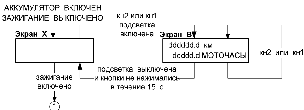
Рисунок 3.1 — Алгоритм вывода сообщений на монитор при выключенном зажигании
