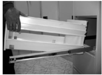
Ящик вставлять под наклоном (рис.36) так, чтобы уголок задней стенки ящика зашел в П-образный отгиб кронштейна направляющих (рис.36(а) и 36(б)), а Г-образный упор встал в вырез дна ящика, как показано на рис.36(в) и 36(г).
