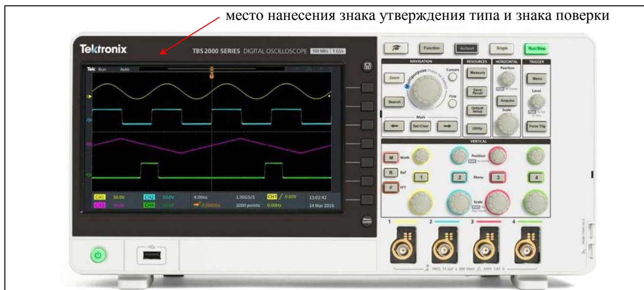
Рисунок 2 - Вид лицевой панели моделей TBS2074, TBS2104
