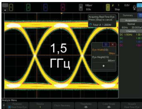
Сигнал частотой 1,2 ГГц на экране осциллографа с полосой пропускания 1,5 ГГц
