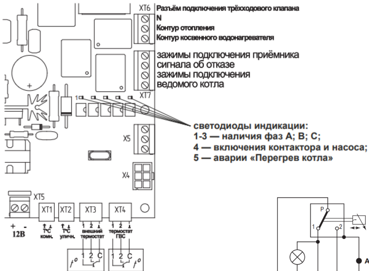
Рис. 1 Схема коммутационной платы котла STOUT.
