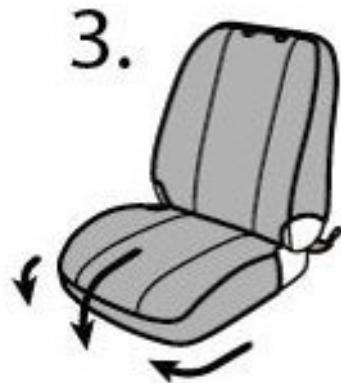
Наденьте чехол на нижнюю часть кресла, равномерно распределив натяжение ткани по поверхности сиденья.
