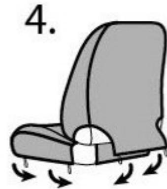
С помощью крючков и резинок прикрепите его верхнюю и нижнюю части к днищу сиденья. Добейтесь плотного прилегания чехла к поверхности кресла.
