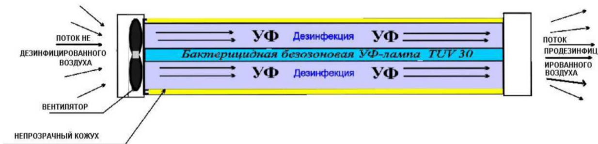
Рисунок 1 Устройство рециркулятора ESP 75.150 металлический корпус
