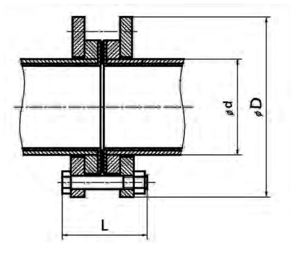
Кожух **РИЗУР - Ф - Н - 0** (-60..+630) - **X** - **D**=100мм - **d**=40мм - **L\***=130мм
