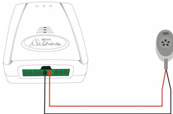
В комплект поставки входит проводной датчик температуры DS18S20 в пластиковом корпусе. Датчик предназначен для управления прибором отопления по температуре воздуха внутри помещения.
