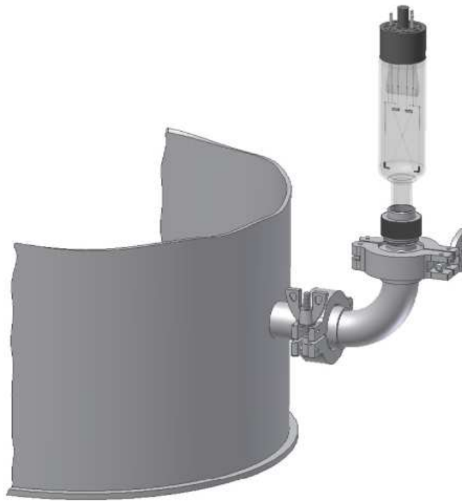
Схема подключения датчика ПМТ-2 к вакуумной системе
