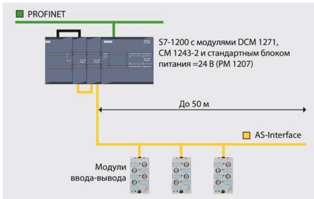
Разделительный модуль DCM 1271 позволяет использовать для питания сети AS-Interface стандартный блок питания =24 В:
