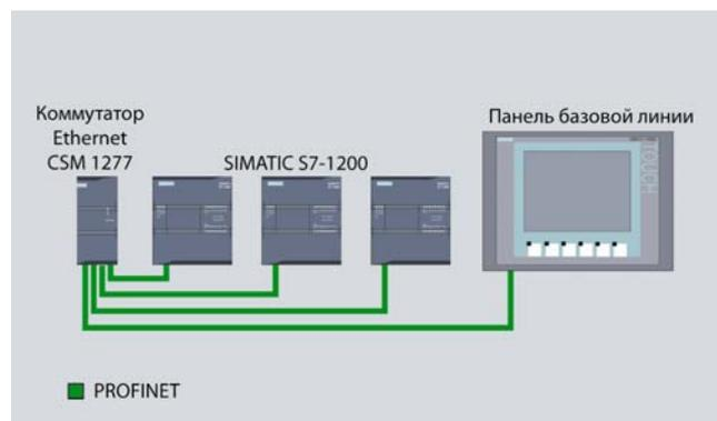
Модуль CSM 1277 выполняет функции коммутатора Ethernet, предназначенного для использования в составе программируемого контроллера S7-1200. С его помощью можно получить три дополнительных интерфейса Ethernet для организа-
