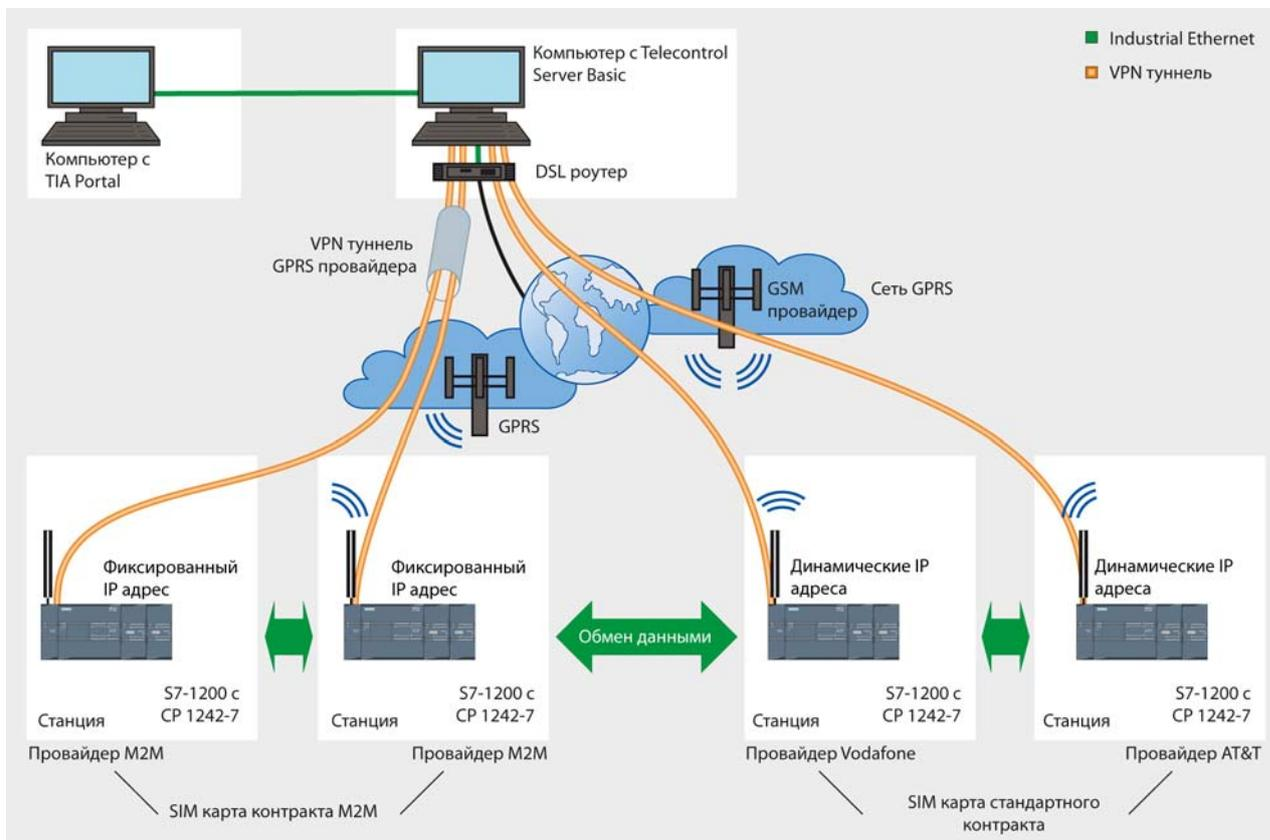
Программируемый контроллер S7-1200 с модулем CP 1242-7 позволяет получать рентабельные решения:
